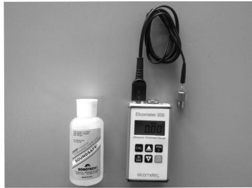
Medidor ultrasónico de espesor
