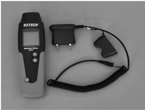
Medidor de humedad en maderas
