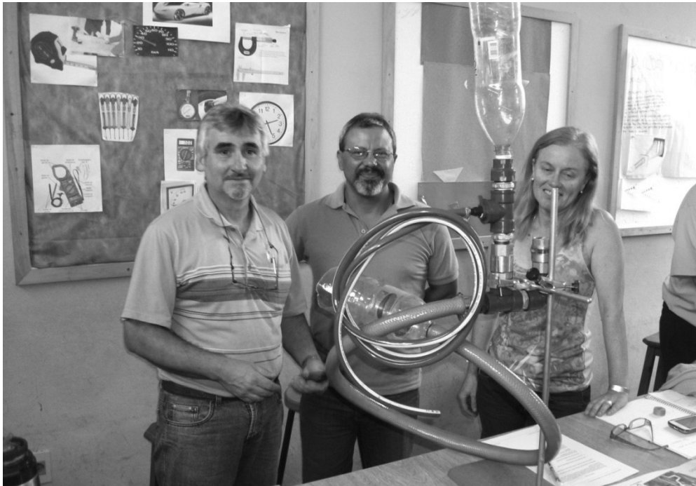
Figura 4. Construcción de un modelo de bomba de ariete (o ariete hidráulico). Instituto Tecnológico Superior Salto.
